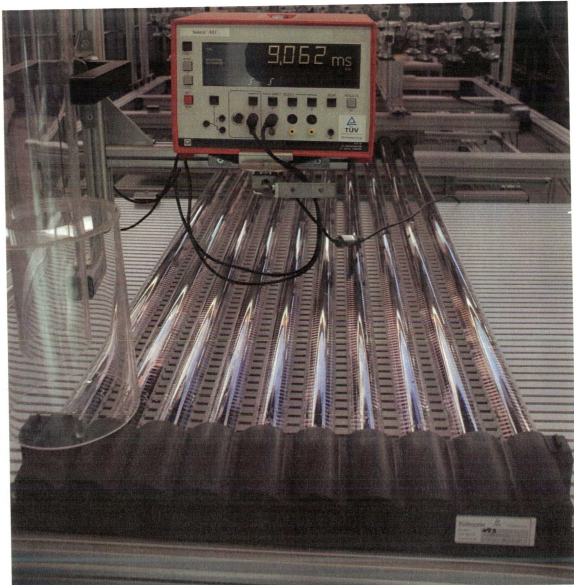
Bild 4: Kollektor nach bestandener Hagelschlagprüfung
